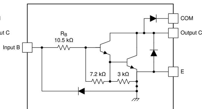
図 7-3. ULN2004A および LQ2004A のブロック図
