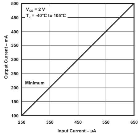
図 5-8. 最小出力電流と入力電流との関係
