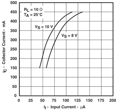
図 5-3. コレクタ電流と入力電流との関係
