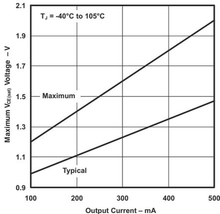
図 5-7. 飽和電圧  $V_{CE}$  (最大値、標準値) と出力電流との関係
