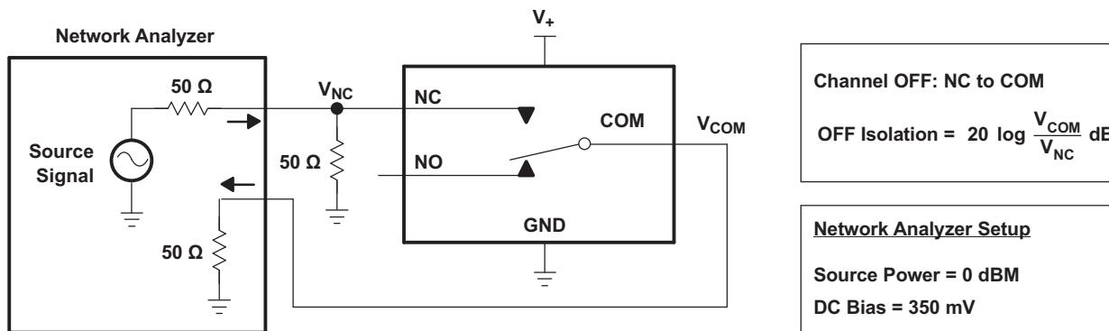
Figure 15. OFF Isolation ( $O_{\text{ISO}}$ )
