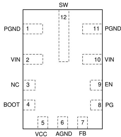
图 5-1. 12-Pin VQFN RNX Package (Top View)
